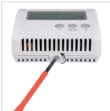
Obr. 1 Vyskrutkujte aretačnú skrutku a odoberte elektroniku termostatu.
